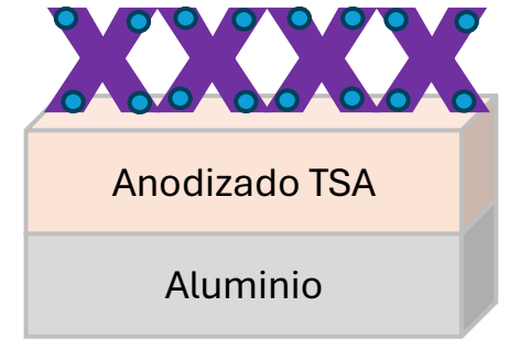
Paso 3. Incorporación de inhibidores en la capa LDH ( \text{NaVO}_3 )
