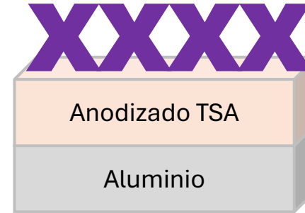
Paso 3. Incorporación de inhibidores en la capa LDH ( \text{NaVO}_3 )
