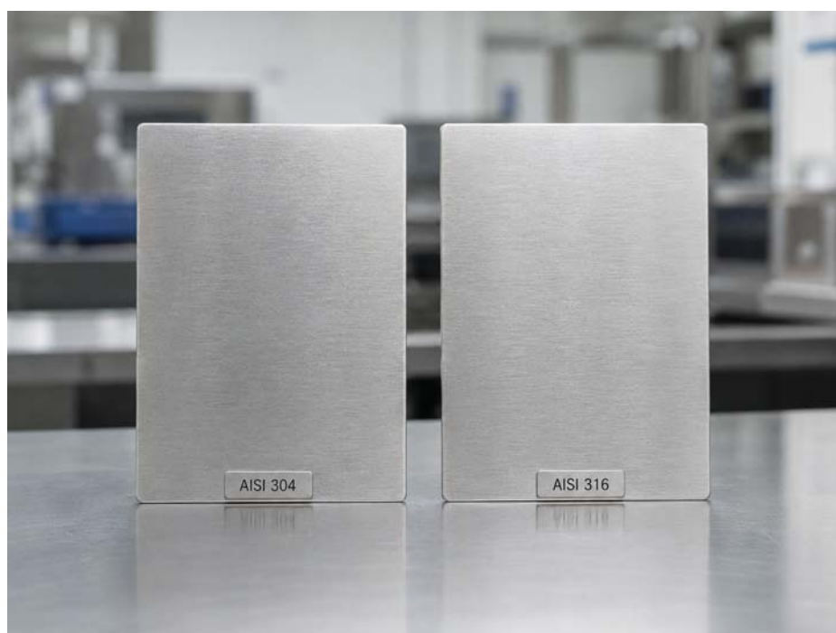
Figura 1. Dos calidades visualmente similares pueden comportarse de forma distinta en servicio. La diferencia relevante entre 304 y 316 no es estética, sino metalúrgica y funcional.
