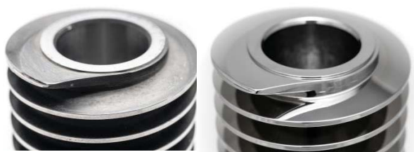
Tornillo de transporte antes (izquierda) y después (derecha) del mecanizado mediante el proceso Streamfinish de OTEC
