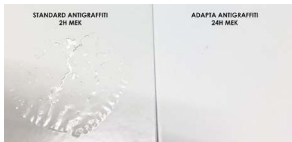
Comparación de los resultados de la prueba de resistencia MEK entre una pintura estándar antigraffiti y la pintura anti-graffiti HCR de ADAPTA.
