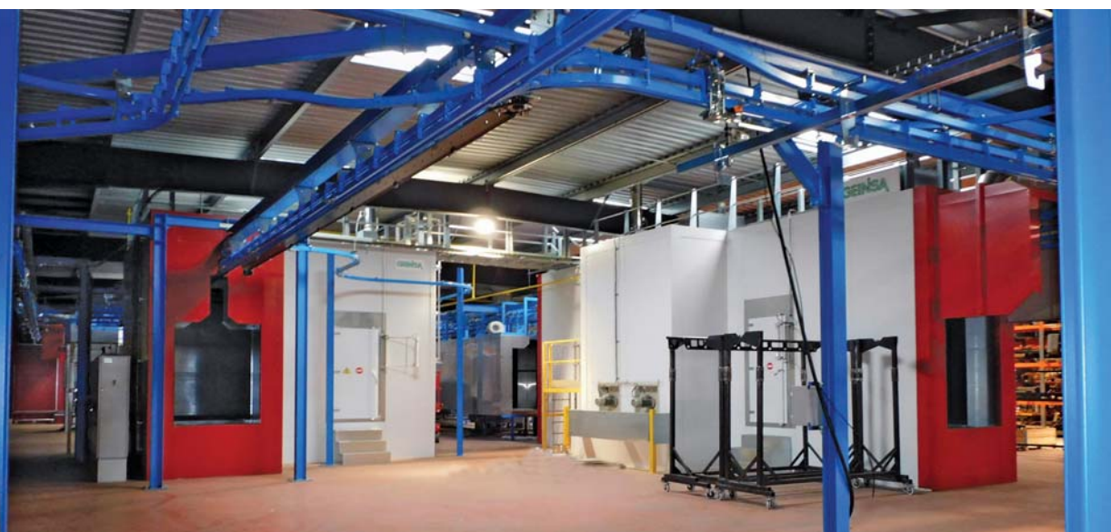
Vista general de la instalación y cabina para aplicación de pintura en polvo.
