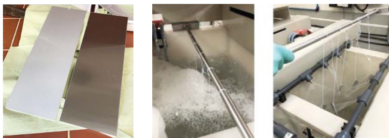
Figura 3. Imágenes de los paneles de referencia Al 2024 durante la aplicación por inmersión en la planta piloto de CHEMPLATE.
