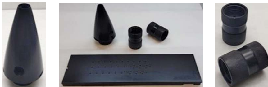
Figura 6. Imágenes de los prototipos de piezas reales con el tratamiento superficial (e-coat) acabado.
