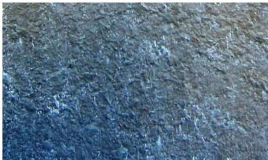
Fig. 2: La adherencia de una capa de zinc electrolítico sobre un revestimiento de zinc lamelar es bastante baja. La creación de hidrógeno durante el proceso de revestimiento conduce a la avulsión del revestimiento de zinc lamelar.
