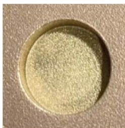
Figura 3. Descincificación de un latón.
