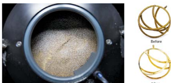
Figura 4. Electrolito sólido proceso DryLyte®.
