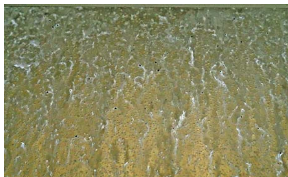
Fig. 6: Formación de ampollas tras 192 h de ensayo de niebla salina (ISO 9227). Sistema de recubrimiento: Cincado electrolítico (4 µm) + pasivación de capa gruesa sin Co + recubrimiento de zinc lamelar (8 µm).
