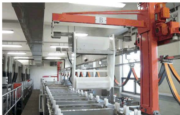
Fig 1: Típica línea electrolítica a bombo para tratamientos en masa.
