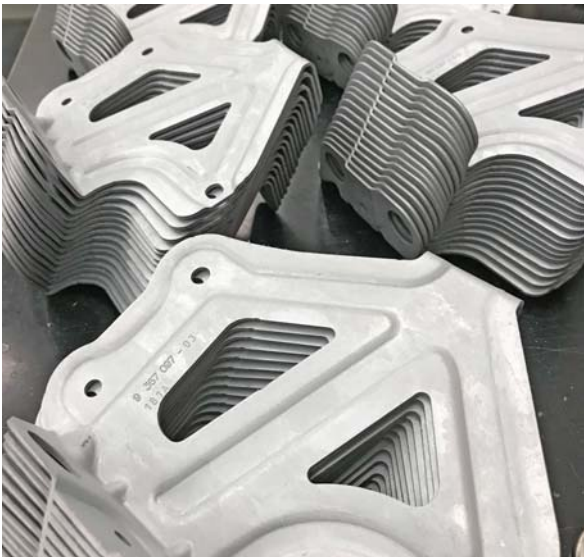
Piezas pintadas y decapadas con el proceso Master Remover de Atotech
