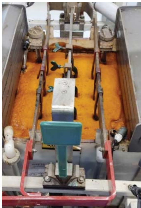
FUMALOCK® capa de espuma que cubre completamente la superficie del tanque electrolítico
