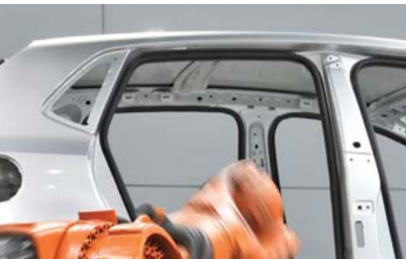
Figura 1: Idealmente, todos desearíamos tener cero sobre-pulverización de pintura y las técnicas de aplicación pintura se mejoran continuamente para aumentar la transferencia de la pintura de la pistola a la pieza.
