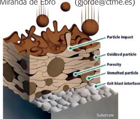
Figura 1. Ejemplo representativo de recubrimiento por proyección térmica.
