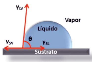
Figura 1. Ángulo de contacto ( \theta ) de una gota de agua sobre la superficie de un sustrato sólido mostrando la tensión superficial de las tres interfaces.
