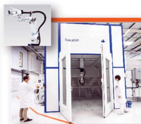
Cabina de pintura con robot de esprayado KUKA READY2SPRAY
