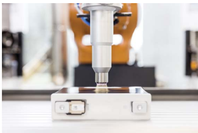
Activación superficial de la lámina negra de una célula prismática antes de la unión célula a célula. (Derechos de autor: Plasmatreteat GmbH)
