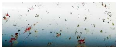
Figura 4. Fotografía representativa de los residuos de impacto de insectos sobre la superficie de un borde de ataque.
