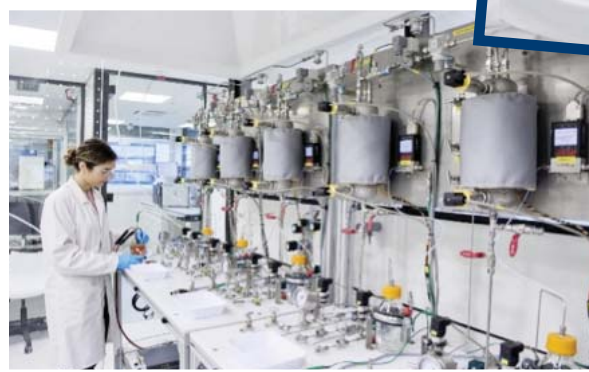
Bancada de testeo a nivel de celda de electrolizador
