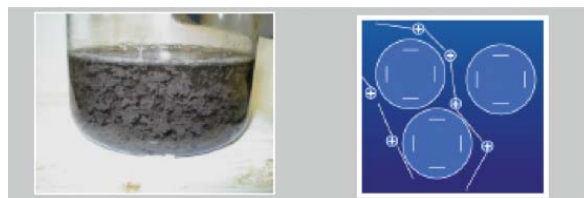
La formación de flóculos mediante fuerzas electrostáticas.
