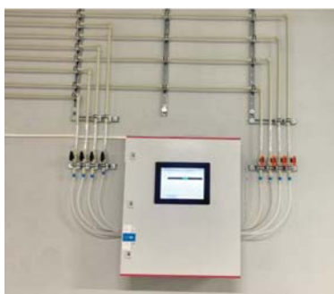
Figura 4. Instalación MasterXRF® para el análisis de cuatro líneas de ZnNi en tiempo real (por cortesía de la firma KNOBLAUCH Galvanotechnik)
