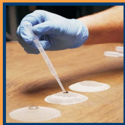
Prueba penetración del agua en la mezcla operativa
