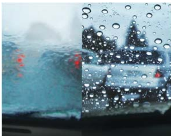
Figura 2. Superficie de vidrio con un acabado hidrofílico (izquierda) e hidrofóbico (derecha).
