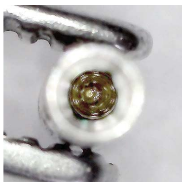
1. Pieza en estado inicial Sucia de aceite y virutas
