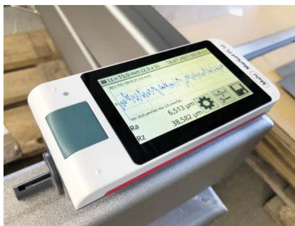
Medición de la rugosidad en el material de granallado para el control de la superficie.
