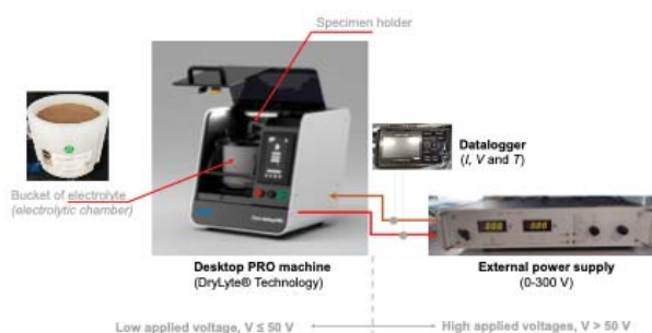
Figura 1. Esquema experimental empleado para realizar el proceso de electropulido en seco y posteriormente el proceso de anodizado. En la representación esquemática, I, V y T hacen referencia a la intensidad, voltaje y temperatura, respectivamente (Figura adaptada de la Ref. [26]).
