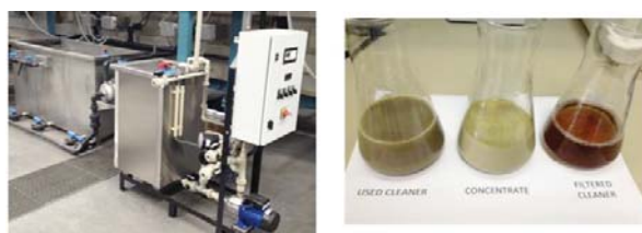
Figura 15- Equipo de desaceitador de lamelas y ultrafiltración, a la derecha los productos de concentrado y filtrado.
