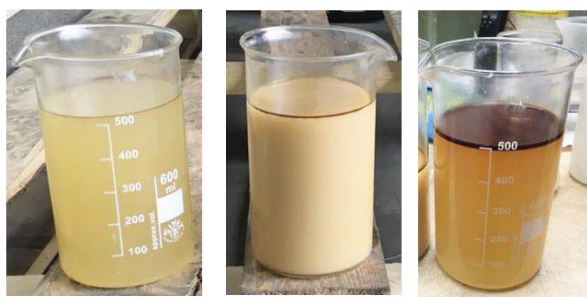
Figura 13- De izquierda a derecha: SurTec 042 nuevo, centro: después de trabajar y saturarse de aceites sin reponer tensioactivo y derecha: desulsionado después de aditar tensioactivo adecuado.
