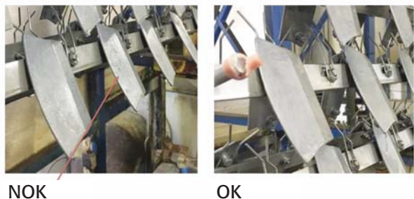
Figura 8- Piezas con película no uniforme a la izquierda y con película uniforme a la derecha.
