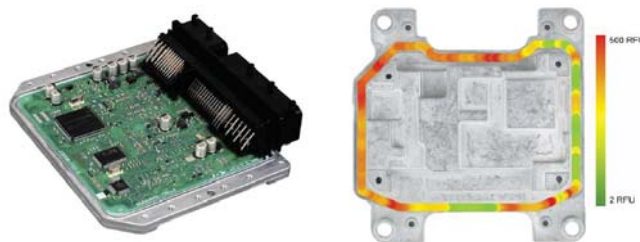
Figura 10- Debido al proceso productivo la suciedad puede distribuirse de forma diferente. La Fluorescencia permite determinar estos patrones.
