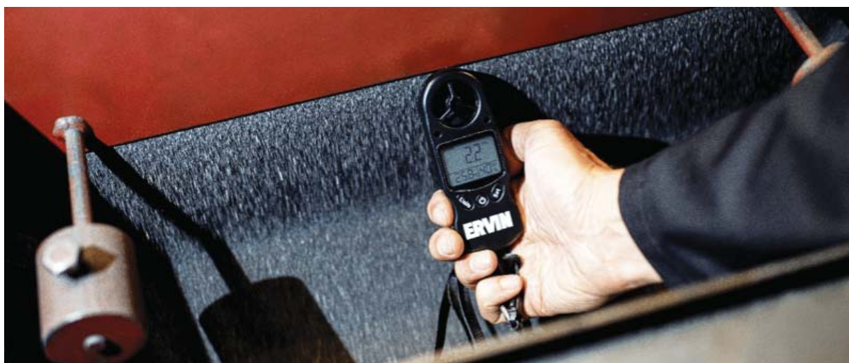
Comprobación de la velocidad del separador de aire
