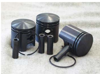
Componentes de motor recubiertos con lubricante sólido de MoS 2
