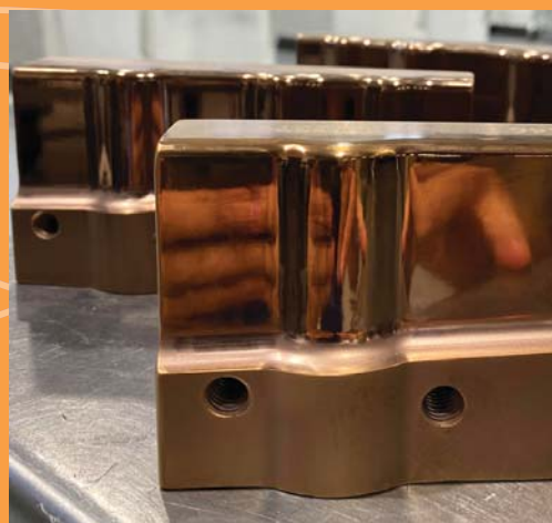
Matrices de embutición de chapa de acero recubiertas con AlTiCN
