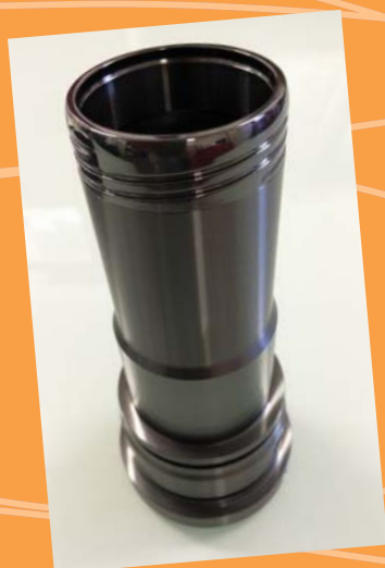
Componente de un molde de packaging alimentario recubierto con DLC
